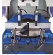
· Ajuste continuo del ángulo de inglete.
