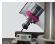
Cabezal · Inclinación lateral ±45°.
