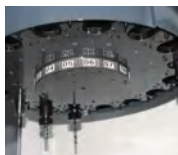
Cambio de herramientas · Automático con 24 ranuras.
