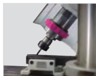
Cabezal · Inclinación lateral \pm 45^\circ .
